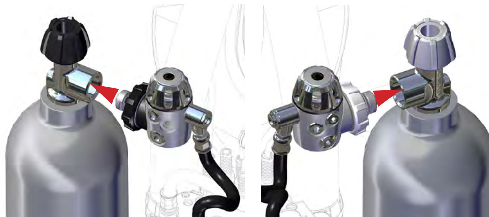
Bild 1-39. Placera 1:a steget för diluentgas i linje med honkontakten på DIN gängen på diluentflaskan. Tryck in den och dra åt snurrmuttern för hand.
