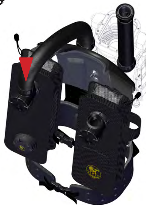
Bild 1-31. Anslut den högra bakre andningsslangen till baksidan av T-kopplingen.
