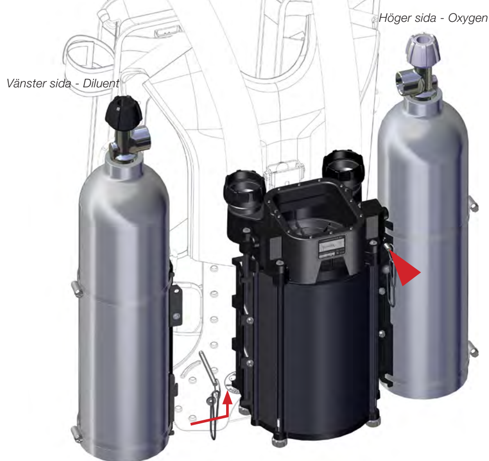
Bild 1-33. Diluentflaskan (svart kran-hatt) sitter monterad på enhetens vänstra sida och syrgasflaskan (vit kran-hatt) sitter monterad på enhetens högra sida.
