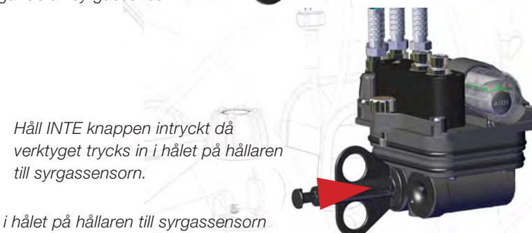
Bild 4-1. Verktøj för borttagande av syrgassensor.
