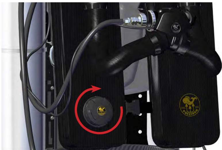
Bild 1-70. Kontrollera att övertrycksventilen är helt stängd.
