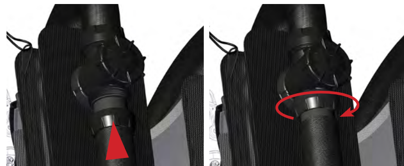
Bild 1-48. Skruva för hand (medurs) fast den främre andningsslangen på T-kopplingen. Använd INTE verktyg.
