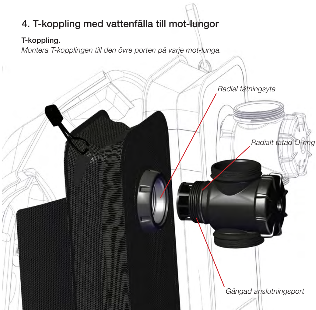
Bild 1-23. För in den högra T-kopplingen i porten på den högra mot-lungan.
