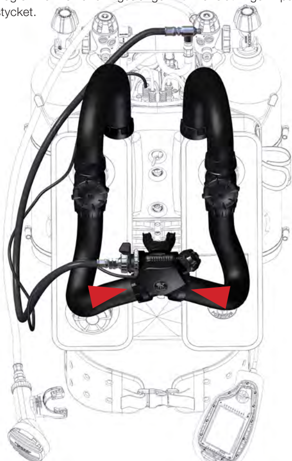
Bild 1-49. Andningsslangar korrekt anslutna till andningsmunstycke.
