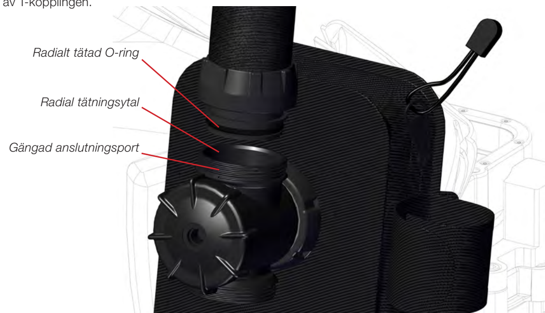
Bild 1-32. Anslut den vänstra bakre anslutningsslangen till den vänstra T-kopplingen.
