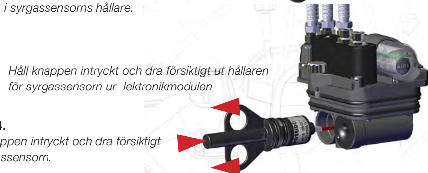
Bild 4-3. Tryck på vertygets knapp, för att låsa verktyget på plats i syrgassensorns hållare.
