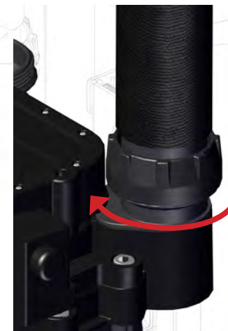
Bild 1-30. Skruva fast löpmuttern med handkraft. Använd inga verktyg och ta inte i för hårt.
