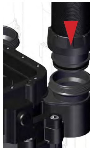
Bild 1-28. Närbild på slanganslutningen.
