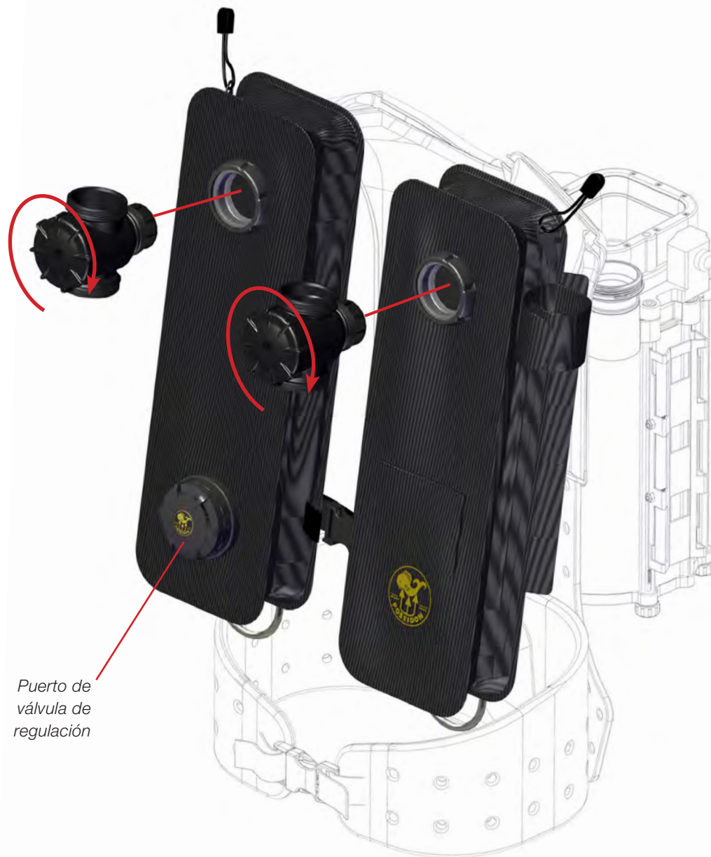
Figura 1-24. Apriete en sentido horario el colector de desviación de agua en el puerto de hombro del contrapulmón izquierdo y derecho.
