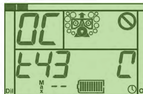
Figura 2-7. Test 43 (Boquilla en posición OC), mostrando el icono de circuito-abierto para indicar que la boquilla debe colocarse en posición de circuito-abierto.
