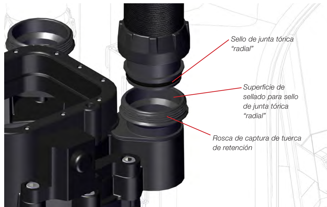
Figura 1-12. Sello de junta tórica tipo “radial” común.
