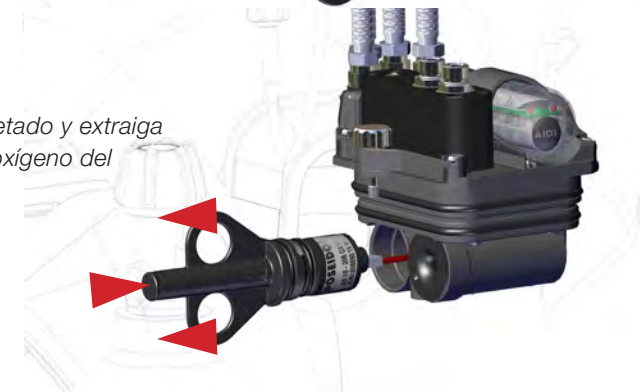
Figura 4-4. Extraiga el sensor presionando el botón.
