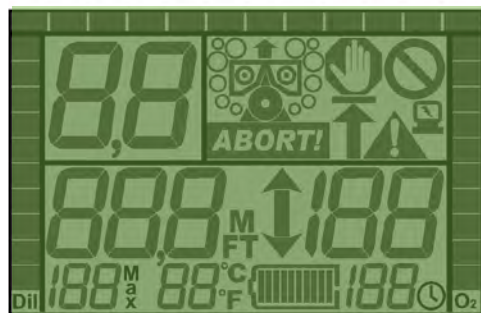
Figura 2-4. La pantalla principal mostrando todos los elementos de la LCD.
