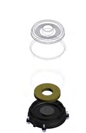
Figura 1-61. Levante y extraiga la esponja inferior; inspeccione el agua recogida.
