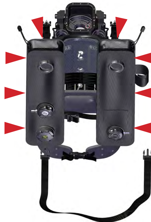
Figura A2-3. Sujete la parte superior del contrapulmón con la hebilla de conexión rápida de longitud ajustable. Coloque las tres aletas de retención de velcro en las cinchas del arnés de la plataforma.
