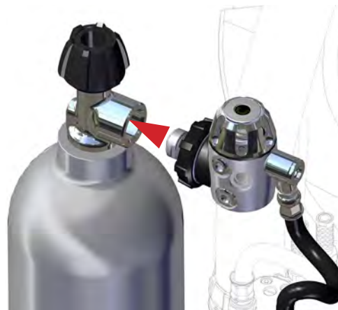
Figura 1-39. Alinee el regulador de diluyente con la rosca DIN hembra de la botella de diluyente. Presiónela y apriete manualmente la tuerca del regulador de diluyente.
