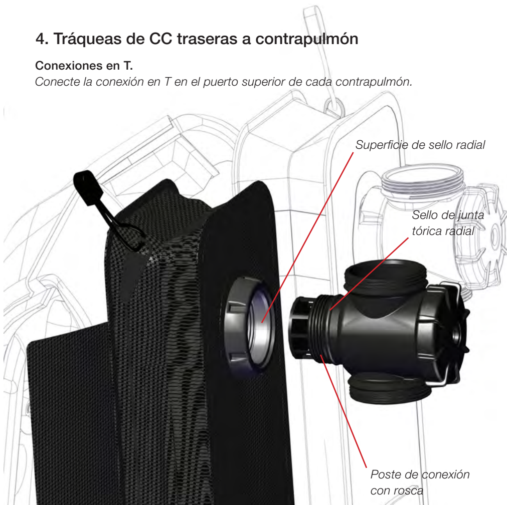
Figura 1-23. Inserte el colector de desviación de agua derecho en el puerto del contrapulmón derecho.
