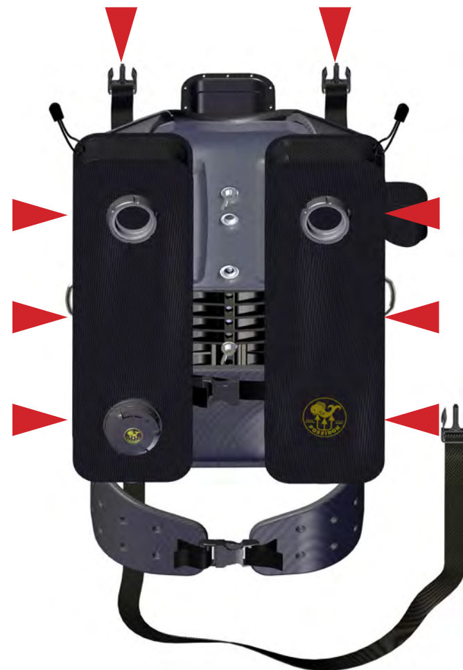
Figura 1-22. Sujete la parte superior del contrapulmón con la hebilla de conexión rápida de longitud ajustable. Coloque las tres aletas de retención de velcro en las cinchas del arnés de la plataforma.
