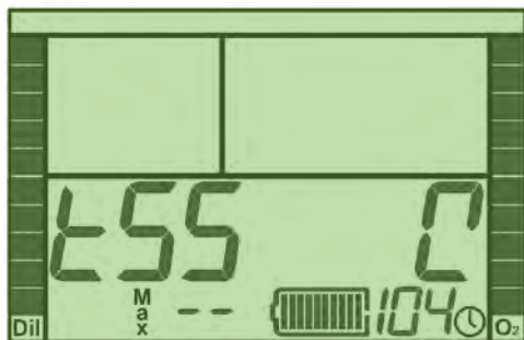
Figura 2-12. Test 55 – Verificación de intervalo de servicio.
