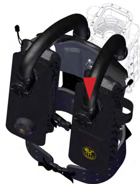
Figura 1-32. Conecte la tráquea respiratoria posterior izquierda en el puerto del hombro del contrapulmón izquierdo.
