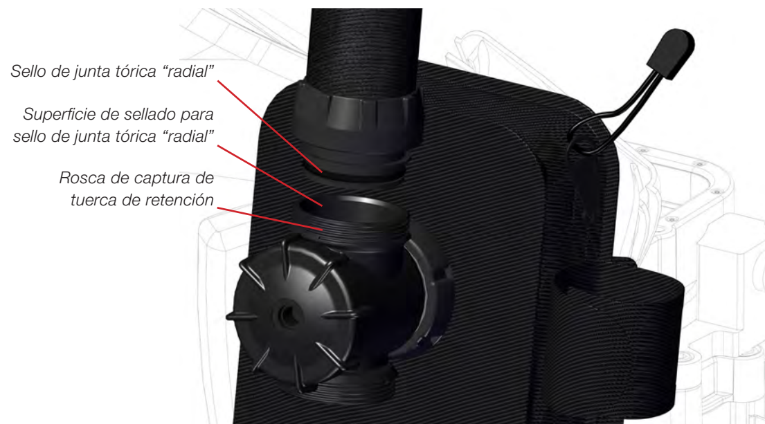
Figura 1-31. Conecte el colector de desviación de agua del contrapulmón derecho en la tráquea respiratoria posterior derecha.
