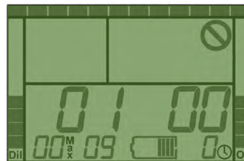
Figura 2-2. Pantallas iniciales durante los primeros cinco segundos de encendido, mostrando la versión del firmware y el número de serie.
