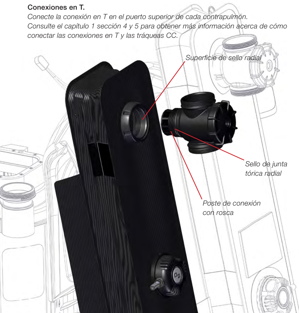
Figura A2-4. Inserte el colector de desviación de agua derecho en el puerto del contrapulmón derecho. Apriete en sentido horario el colector de desviación de agua en el puerto de hombro del contrapulmón izquierdo y derecho. Tenga en cuenta la orientación correcta, tal y como se describe en el capítulo 1, sección 4.
