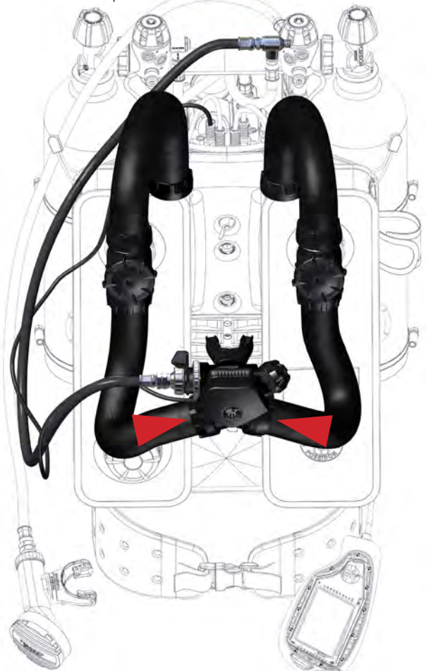
Figura 1-49. Tráqueas respiratorias conectadas correctamente en la boquilla.
