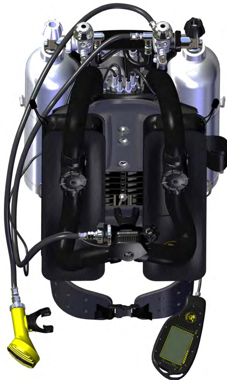
Figura 1-71. Preparado para los tests de pre-inmersión. Según la configuración de esta foto, el Poseidon SE7EN muestra instalada la plataforma opcional del backpack, pero no la aleta compensadora de flotabilidad opcional, la cual está montada detrás de los contrapulmones.
