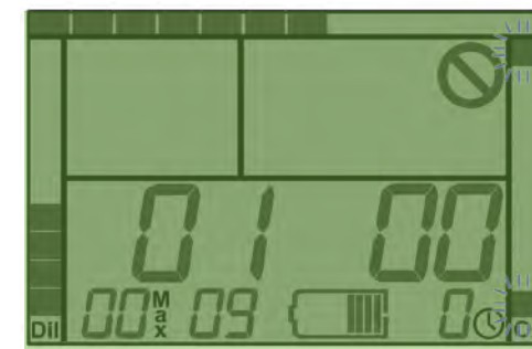
Figura 2-3. Cuando empiezan a parpadear en la pantalla los segmentos superior e inferior, vuelva a conectar los botones de humedad.
