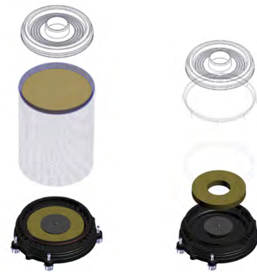
Figura 1-61. Levante y extraiga la esponja inferior; inspeccione el agua recogida.
