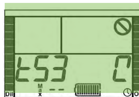
Figura 2-11. Test 53 – Calibración de sensor de oxígeno.
