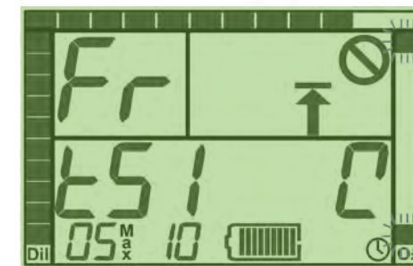
Figura A2-8: Pantallas de confirmación de oxígeno en test 52, indicando los valores alternativos de "O2" (para "Oxígeno"; superior), "Fr" (para "Fracción"; en medio), y un valor numérico (indicando la fracción asumida de oxígeno; inferior) para la mezcla de diluyente.
