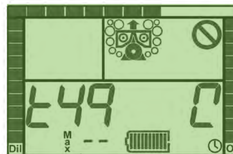
Figura 2-9. Test 49 – Test de circuito de presión positiva.
