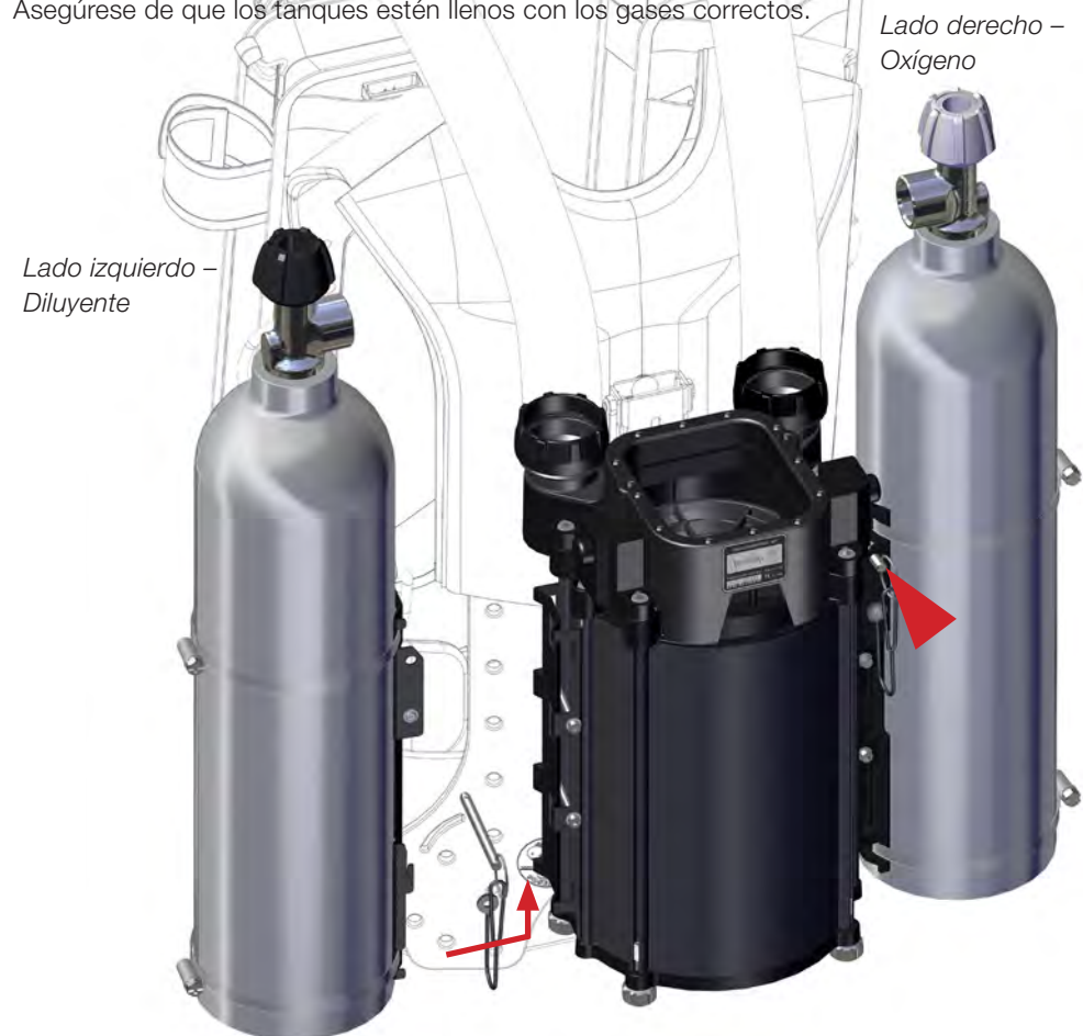
Figura 1-33. El tanque de diluyente (perilla negra) se monta en el lado izquierdo de la unidad y el oxígeno (perilla blanca) en el lado derecho de la unidad.
