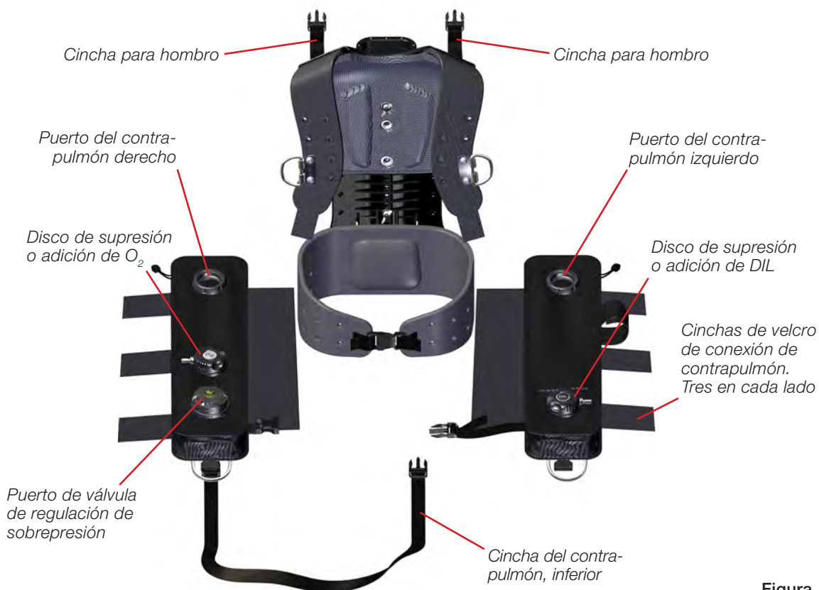
Figura A2-2. Disponga los contrapulmones izquierdo y derecho y sus colectores de desviación de agua.
