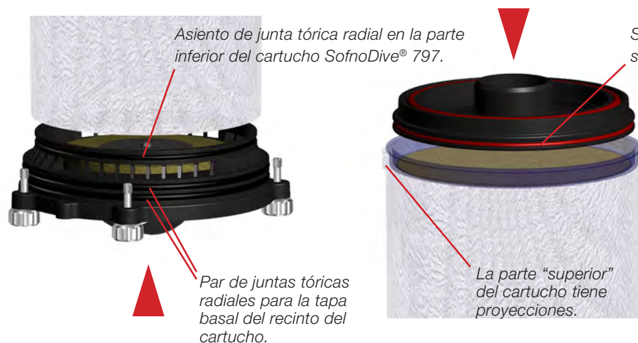
Figura 1-63. Colocación de la tapa basal del cartucho en un nuevo cartucho de recambio de SofnoDive® 797.
