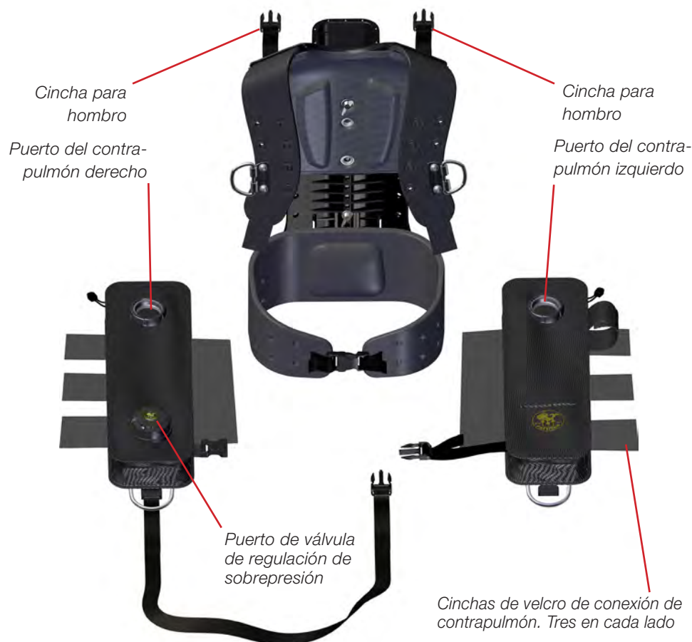
Figura 1-21. Disponga los contrapulmones izquierdo y derecho y sus colectores de desviación de agua.
