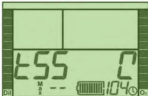
Sobald der Wartungszeitpunkt erreicht ist, wird der Taucher aufgefordert zu bestätigen (ähnlich wie beim „Starten der Elektronik“), dass er oder sie den Wartungsbedarf zur Kenntnis genommen hat. Eine Nachfrist von 4 Wochen wird hinzugefügt. Das Wartungsfälligkeitsdatum kann auch über die PC-Konfigurationssoftware eingesehen werden.
