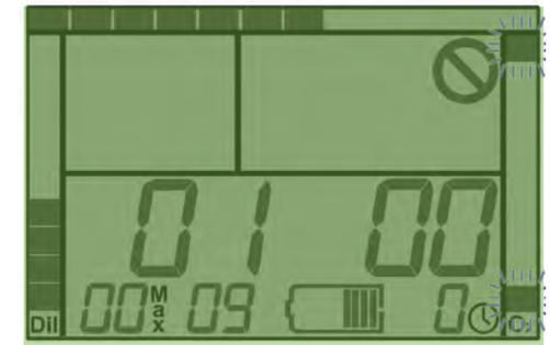
**Abbildung 2-3.** Wenn die oberen und unteren Felder des Displays zu blinken beginnen, verbinden Sie die Nasskontakte erneut.
