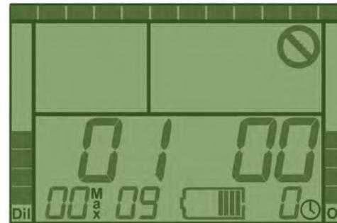
**Abbildung 2-2.** Anfangsanzeigen während der ersten fünf Sekunden des Starts zeigen die Version der Firmware und die Seriennummer.
