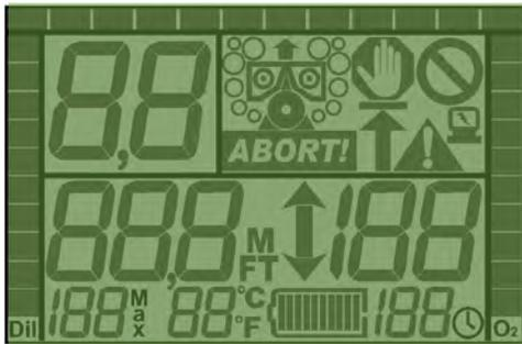
Obwohl es 55 Tests gibt, zeigt das Display nur 36 davon an, da einige Testnummern für zukünftige Tests reserviert sind. Beachten Sie, dass das System bei einer größeren Tiefe als null automatisch in den Tauchmodus springt und den Taucher zum Abbruch des Tauchgangs auffordert, weil der Testablauf vor dem Tauchen nicht beendet wurde.
