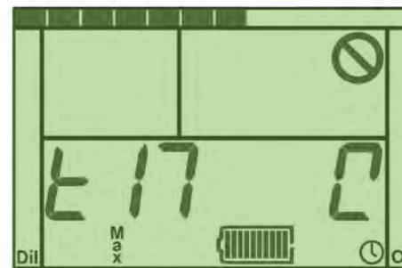
**Bild A1-1:** Test 17 (Leistungsaufnahme der Hintergrundbeleuchtung), zeigt die Testnummer auf der linken Seite und das „sich drehende Rad“ auf der rechten Seite an.
