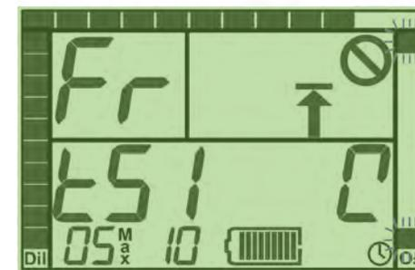
**Abbildung A2-7:** Heliumbestätigungsbildschirme bei Test 51, auf denen die abwechselnden Werte „HE“ (für „Helium“; oben), „Fr“ (für „Anteil“; in der Mitte) und ein numerischer Wert (der den angenommenen Heliumanteil darstellt; unten) für das Verdünnungsgasgemisch angezeigt werden.
