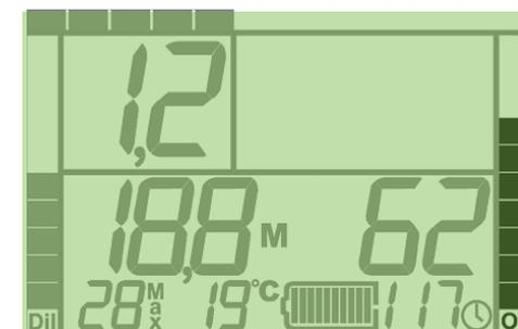
Abbildung 3-32. Druckanzeige der Sauerstoffflasche.
