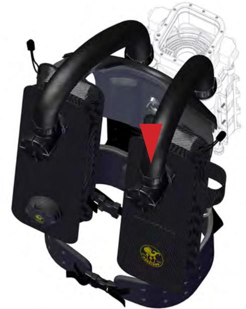
**Abbildung 1-32.** Verbinden Sie den linken hinteren Atemschlauch mit dem Schulteranschluss der linken Gegenlung.
