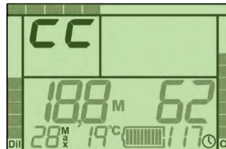
Abbildung 3-17. Modus geschlossener Kreislauf.
