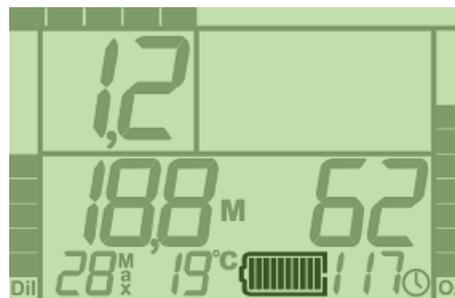
Abbildung 3-29. Anzeige für den Batterieladezustand.
