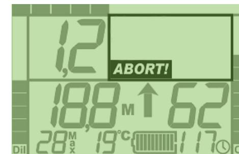
Abbildung 3-7b. Bereich für Alarmsignale.
