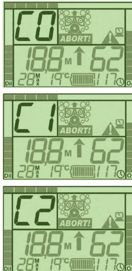
Abbildung 3-16. Alarme zur Sauerstoffsensozuverlässigkeit: C0, C1, C2.
