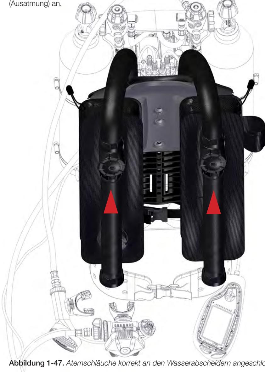
Abbildung 1-47. Atemschläuche korrekt an den Wasserabscheidern angeschlossen.
