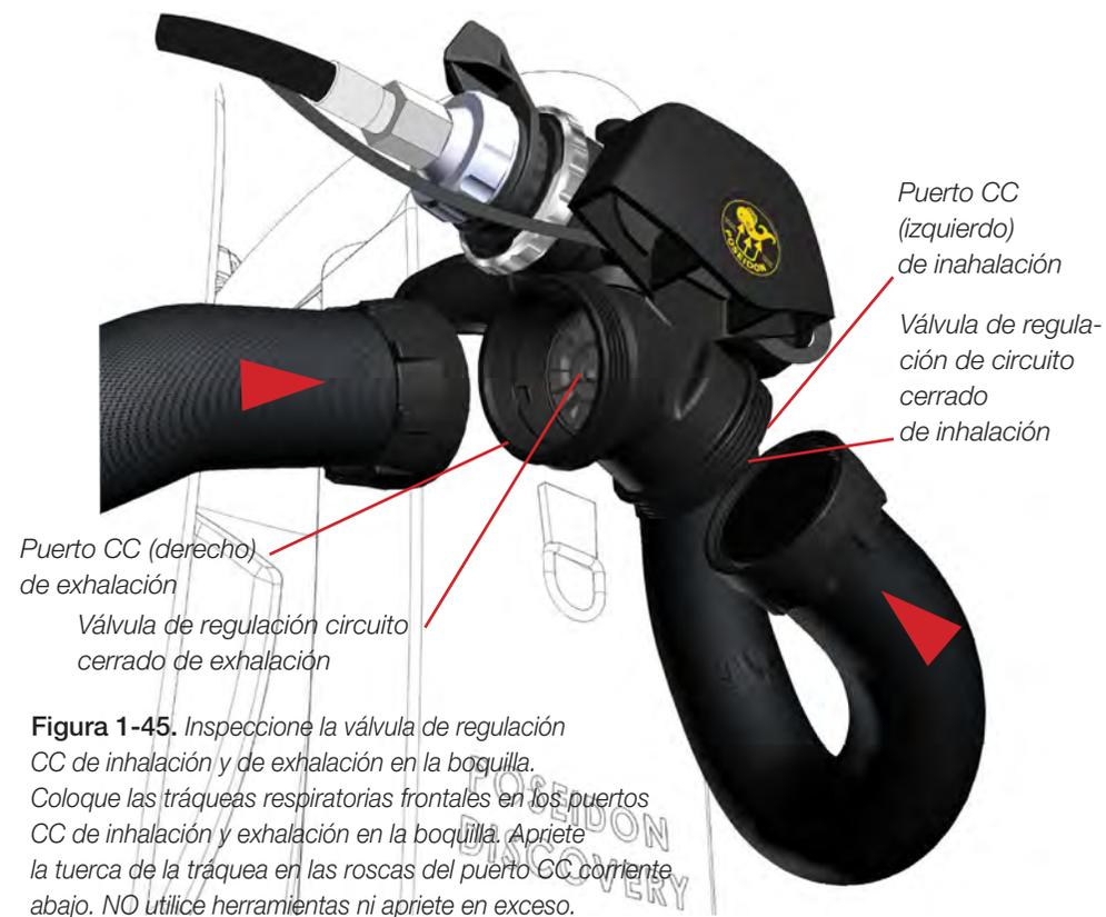
Figura 1-45. Inspeccione la válvula de regulación CC de inhalación y de exhalación en la boquilla. Coloque las tráqueas respiratorias frontales en los puertos CC de inhalación y exhalación en la boquilla. Apriete la tuerca de la tráquea en las roscas del puerto CC corriente abajo. NO utilice herramientas ni apriete en exceso.
