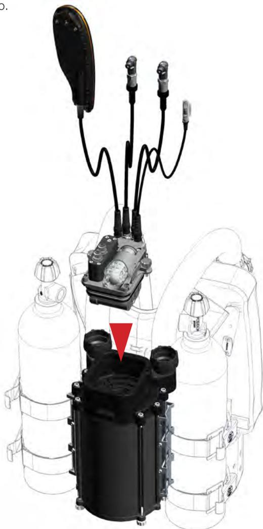
En el corazón del Poseidon MKVI está el sistema electrónico, neumático, de control y el sistema de interacción del usuario. El módulo electrónico, que se muestra en el centro de la Figura 1-29, contiene el ordenador principal del equipo, la batería inteligente, y el bloque de control neumático, montados en un solo bloque compacto enchufar y usar.
