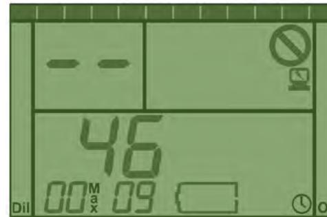
**Figura 2-2.** Pantallas iniciales durante los primeros dos segundos de encendido, mostrando la versión de firmware y el número de serie.
