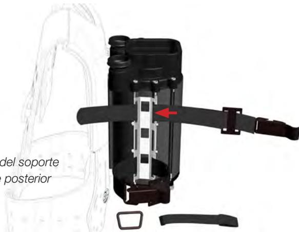
Pase el anillo D de la hebilla de la banda del tanque en la banda del tanque.
