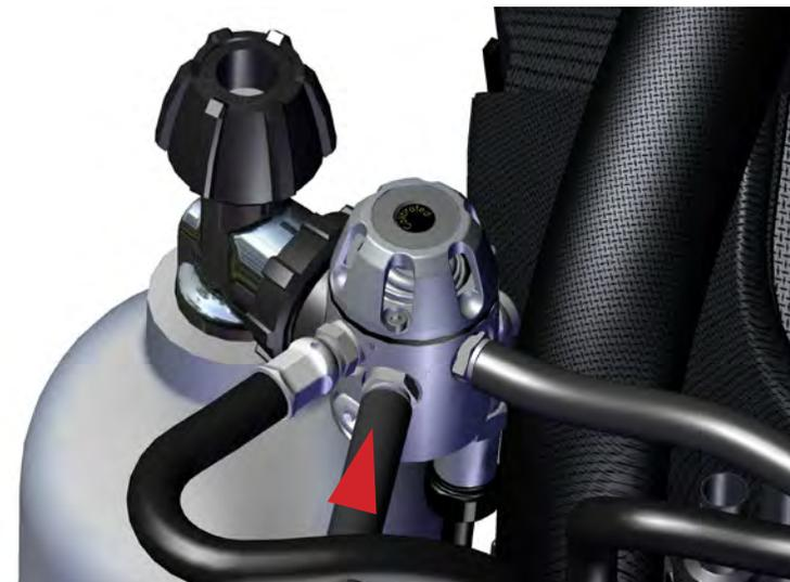
**Figura 1-41.** Conecte la tráquea de baja presión de la fuente de aire alternativa en un puerto de baja presión (marcado como "IP") en el diluyente (rueda de conexión negra) de la 1ª etapa.
