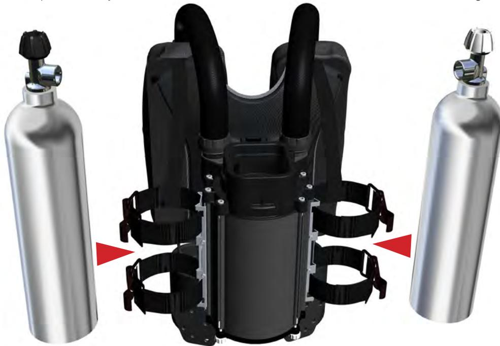
**Figura 1-27.** El tanque de diluyente (perilla negra) se monta en el lado izquierdo de la unidad y el oxígeno (perilla blanca) en el lado derecho de la unidad.
