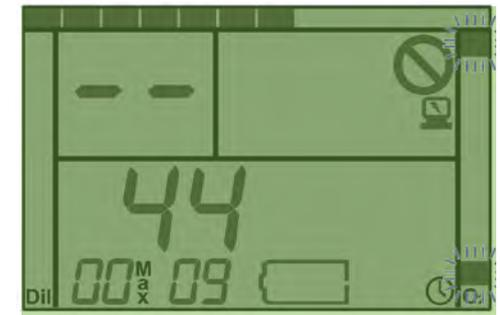
**Figura 2-3.** Cuando empiezan a parpadear en la pantalla los segmentos superior e inferior, vuelva a conectar los botones de humedad.
