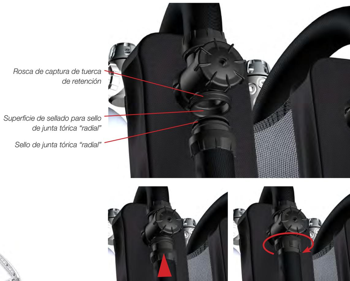
Figura 1-43. Apriete manualmente (sentido horario) las tuercas para la tráquea respiratoria frontal en los puertos de hombro frontales. NO utilice herramientas ni apriete en exceso.
