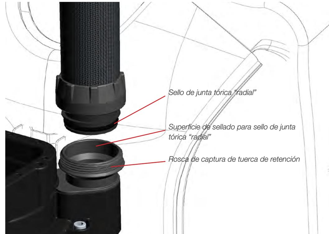
**Figura 1-11.** Sello de junta tórica tipo "radial" común.
