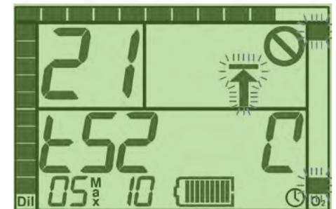
**Figura A2-3:** Pantallas de confirmación de helio en test 51, indicando los valores alternativos de "HE" (para "Helio"; superior), "Fr" (para "Fracción"; en medio), y un valor numérico (indicando la fracción asumida de helio; inferior) para la mezcla de diluyente.
