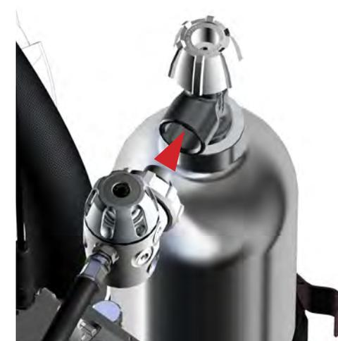
**Figura 1-34.** Alinee el regulador de oxígeno con la rosca DIN hembra de la botella de oxígeno. Presiónela y apriete manualmente la tuerca del oxígeno.
