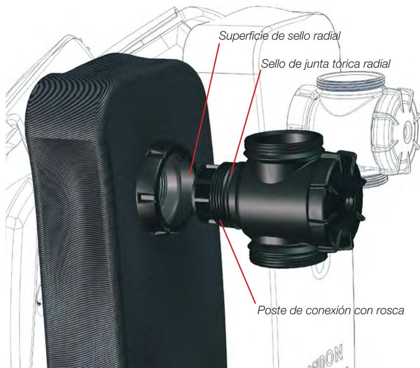
**Figura 1-17.** Inserte el colector de desviación de agua derecho en el puerto del contrapulmón derecho.
