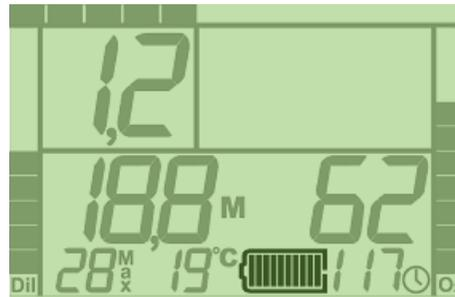
Figura 3-29. Indicador de vida útil de batería.
