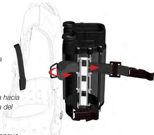
Doble la banda del tanque y pásela hacia atrás a través de la misma apertura del soporte de la banda del tanque.
