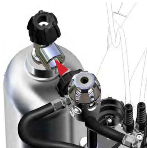
**Figura 1-33.** Alinee el regulador de diluyente con la rosca DIN hembra de la botella de diluyente. Presiónela y apriete manualmente la tuerca del regulador de diluyente.
