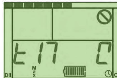
**Figura A1-1:** Test 17 (Consumo de energía de luz de fondo), número de test a la izquierda y la “rueda giratoria” a la derecha.
