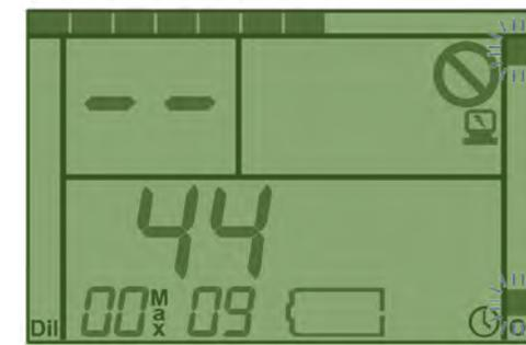
Рис. 2-3. Когда верхний и нижний сегменты дисплея начнут мигать, повторно соедините мокрые выключатели.
