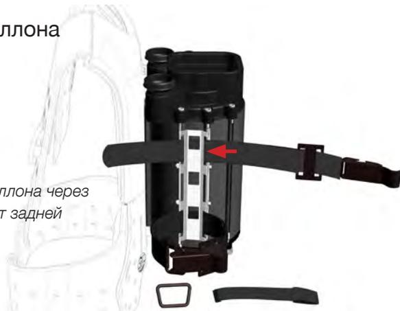
Протяните пряжку ремня крепления баллона Полукруглое кольцо на ремне крепления баллона.
