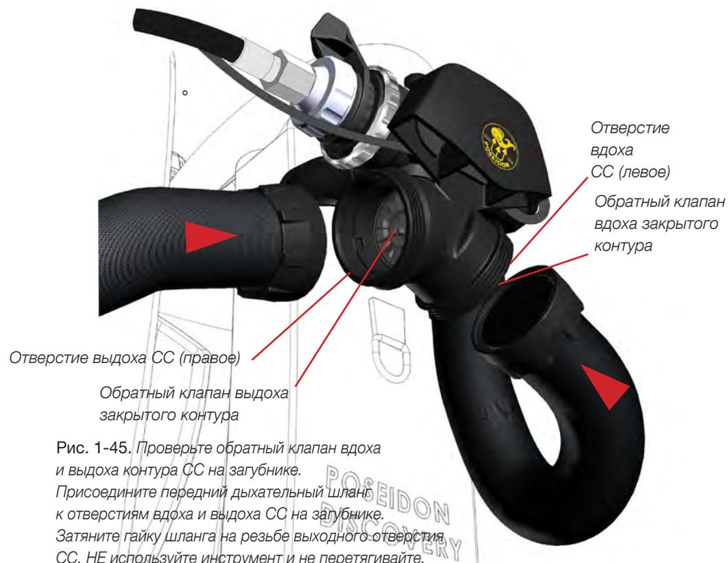
Рис. 1-45. Проверьте обратный клапан вдоха и выдоха контура СС на загубнике. Присоедините передний дыхательный шланг к отверстиям вдоха и выдоха СС на загубнике. Затяните гайку шланга на резьбе выходного отверстия СС. НЕ используйте инструмент и не перетягивайте.
