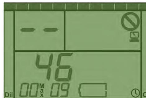
Рис. 2-2. Дисплей с начальной индикацией во время первых двух секунд после включения, показывающие версию прошивки и серийный номер.
