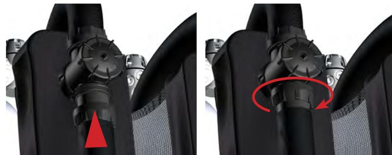
Рис. 1-43. Затяните рукой (по часовой стрелке) накидные удерживающие гайки для передних дыхательных шлангов на передних плечевых соединениях. НЕ используйте инструмент и не перетягивайте.
