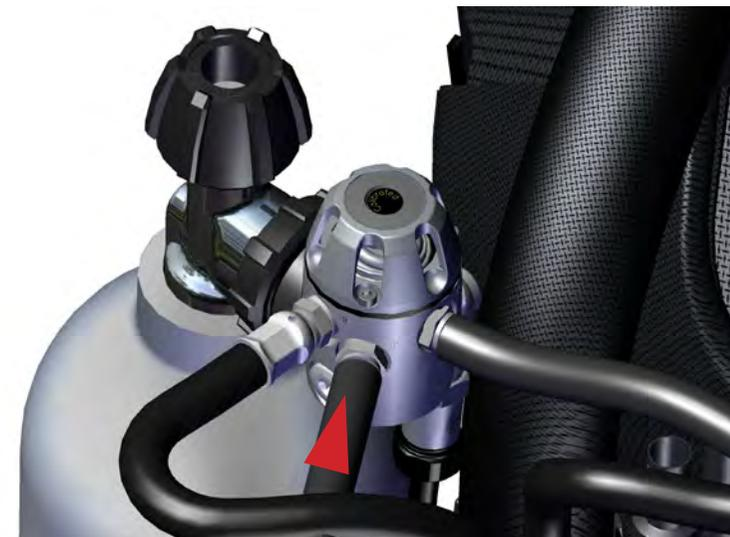
Рис. 1-41. Подсоедините шланг альтернативного источника воздуха к отверстию низкого давления (с маркировкой IP) на 1-ой ступени дилуента (черное соединительное колесико).
