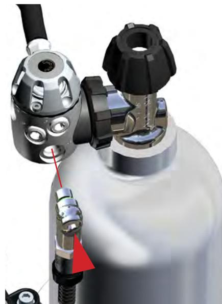
Рис. 1-36. Совместите для дилуента датчик высокого давления, расположенный на модуле электроники к отверстию HP на 1-ой ступени для дилуента. См. Рис. 1-36.
