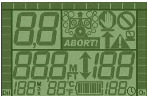
Рис. 2-4. Основной дисплей, показывающий все светодиодные элементы.
