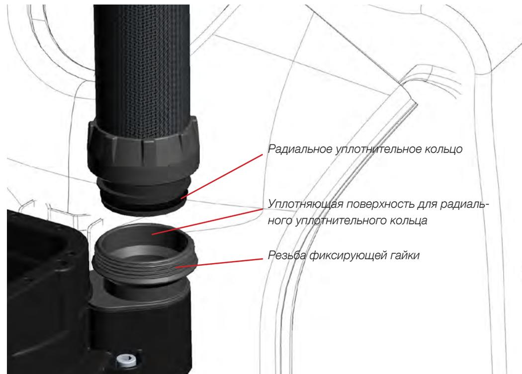
Рис. 1-11. Обычное радиальное уплотнительное кольцо.
