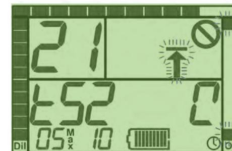
Рис. А2-4: Экраны подтверждения кислорода во время проверки 52, показывающие изменяющиеся значения « $O_2$ » («Кислород»; верхний), «Fr» («Доля»; средний), и числовое значение (указывающее предполагаемую долю кислорода; нижний) для смеси дилуента.
