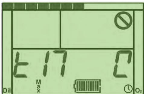
Рис. 2-5. Проверка 17 (потребление энергии подсветкой дисплея), при которой номер проверки отображается слева, а «вращающееся колесико» – справа.
