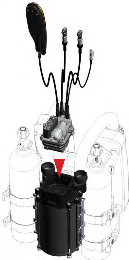
Основными составляющими аппарата Poseidon MKVI являются электронная система, пневматическая система, система управления и системы обратной связи с пользователем. Модуль электроники, показанный в центре Рис. 1-29, содержит систему основного ранцевого компьютера, интеллектуальную батарею, блок управления пневматикой, которые собраны в одном компактном и готовом к работе модуле.
