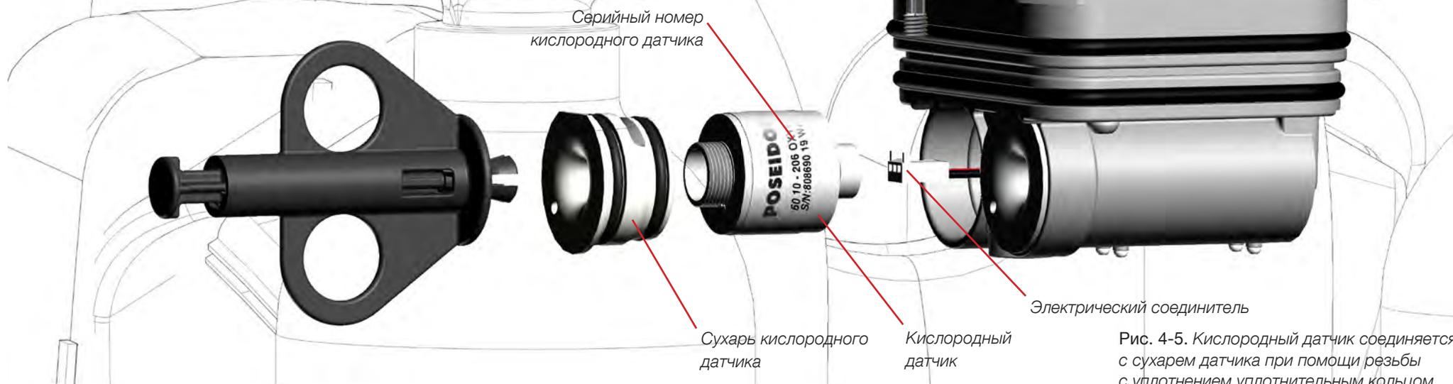
Рис. 4-5. Кислородный датчик соединяется с сухарем датчика при помощи резьбы с уплотнением уплотнительным кольцом.
