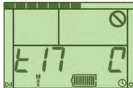
Рис. А1-1: Проверка 17 (потребление энергии подсветкой дисплея), при которой номер проверки отображается слева, а «вращающееся колесико» – справа.
