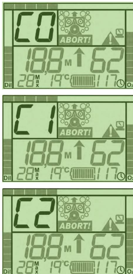
Рис. 3-16. Предупреждающие сигналы достоверности кислородного датчика: C0, C1, C2.
