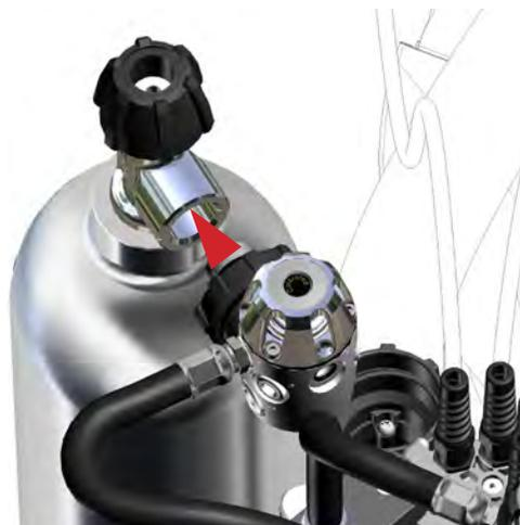
**Рис. 1-33.** Совместите регулятор дилуента с внутренней резьбой DIN баллона дилуента. Вставьте его и затяните рукой накидную удерживающую гайку регулятора дилуента.
