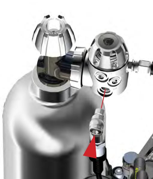
Рис. 1-35. Совместите очищенный для кислорода датчик высокого давления, расположенный на модуле электроники к отверстию HP на 1-ой ступени, очищенной для использования кислорода. См. Рис. 1-35.
