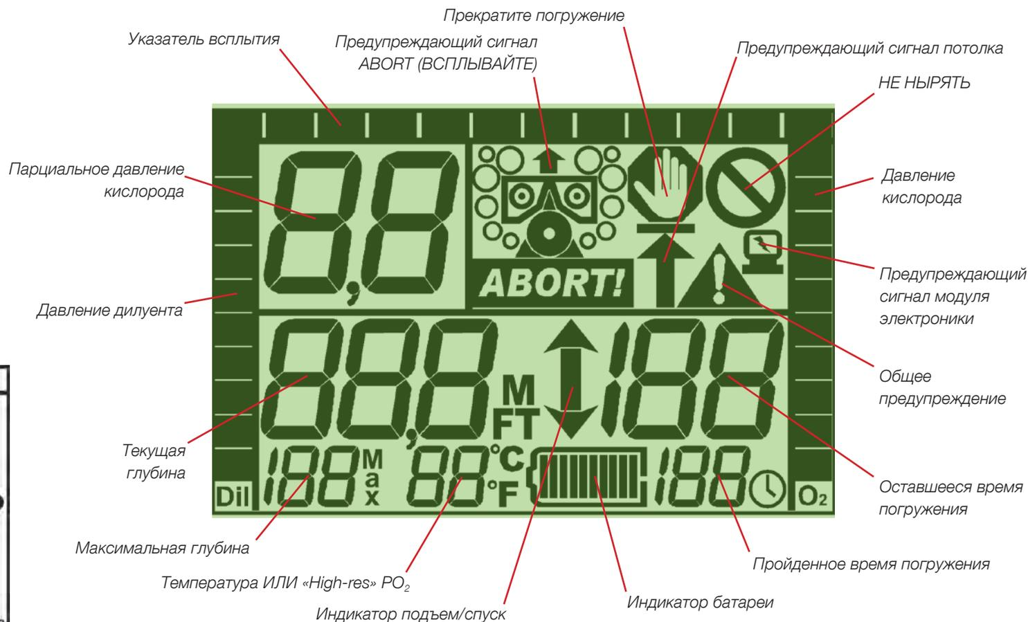
Рис. 3-3. Поля на основном дисплее.
