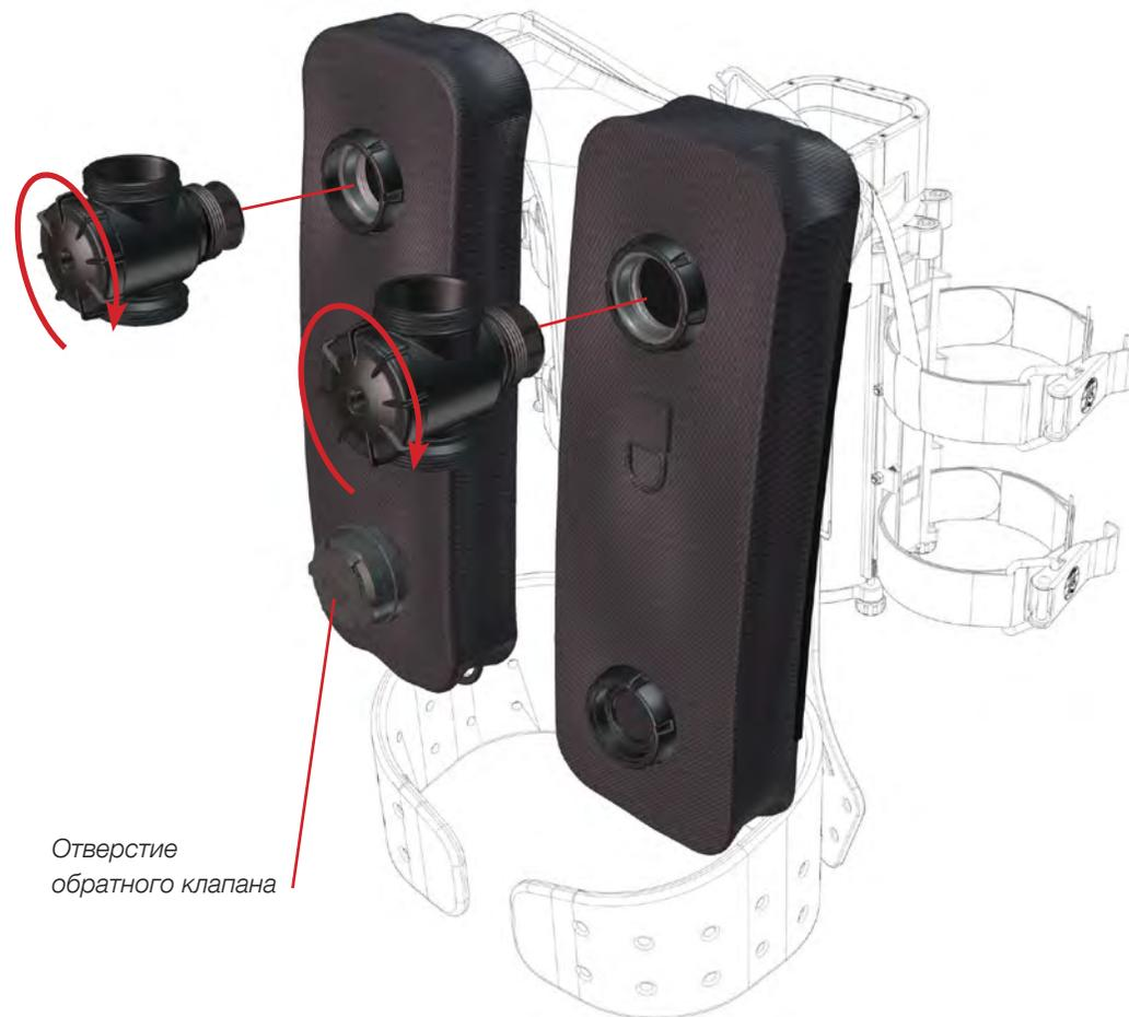
Рис. 1-18. Затяните водоотводный коллектор, поворачивая его по часовой стрелке, на плечевом соединении правого и левого дыхательного мешка.
