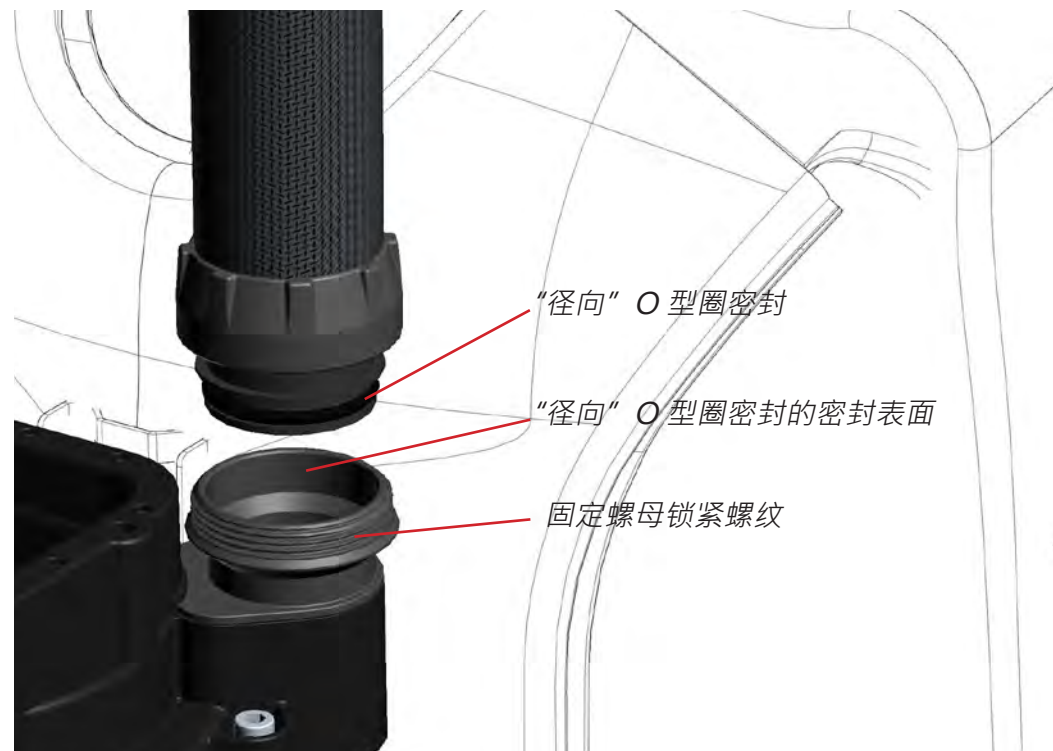
图 1-11. 典型“径向”型 ○ 型圈密封。
