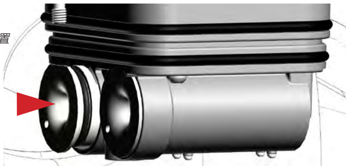
图 4-6. 将新的氧气感应器插入电子装置模块，让感应器底座的平边缘朝前。
