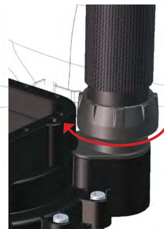
图 1-24. 手动锁紧旋转锁紧螺母： 请勿使用工具或锁得过 紧。
