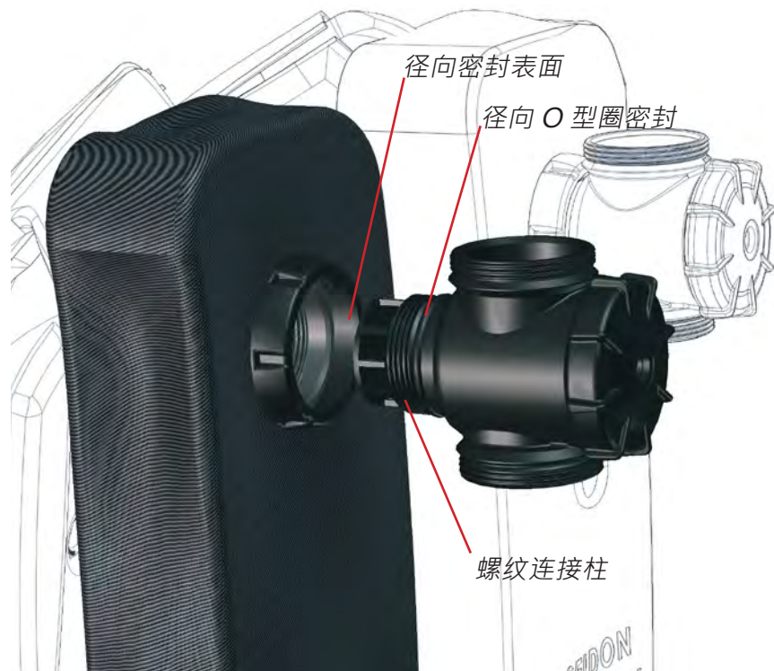
图 1-17.将右分水歧管插入右呼吸袋的接口。
