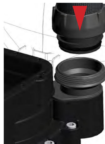
图 1-22. 封闭软管接头。
