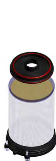
图 1-51. 拆卸吸收剂筒顶板。
