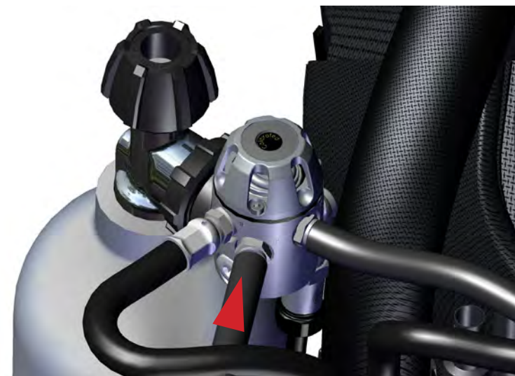
图 1-41. 将替代气源低压软管连接至稀释气（黑色连接轮）一级上的低压接口（标有“IP”字样）。
