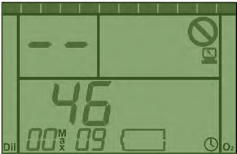
图 2-2.启动电源前两秒钟显示固件版本和序列号的初始显示器。
