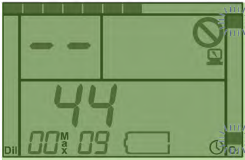
图 2-3.显示器的上下字段开始闪烁时，重新连接湿式开关。
