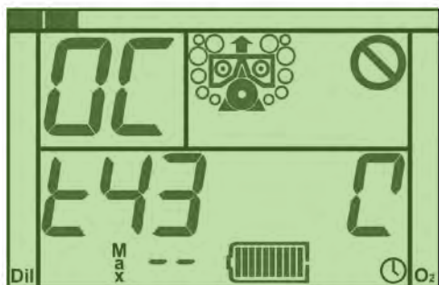
图 2-7. 测试 43 (咬嘴处于开路位置) 显示开路图标，指示咬嘴必须置于开路位置。
