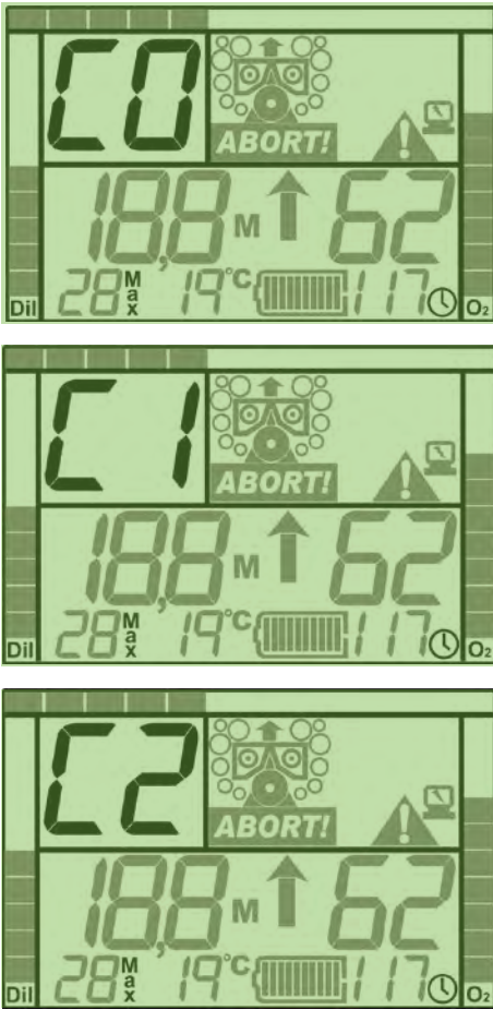
图 3-16. 氧气感应器置信度警报：C0、C1、C2。
