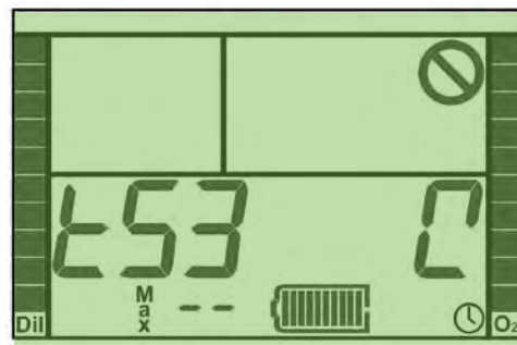
图 2-11.测试 53——氧气感应器校准。
