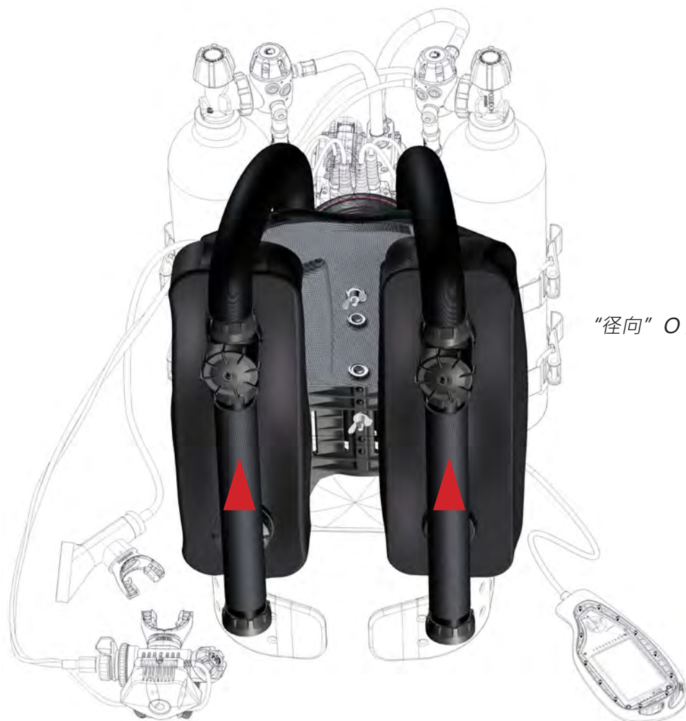
图 1-42. 正确连接至分水歧管上的呼吸软管。
