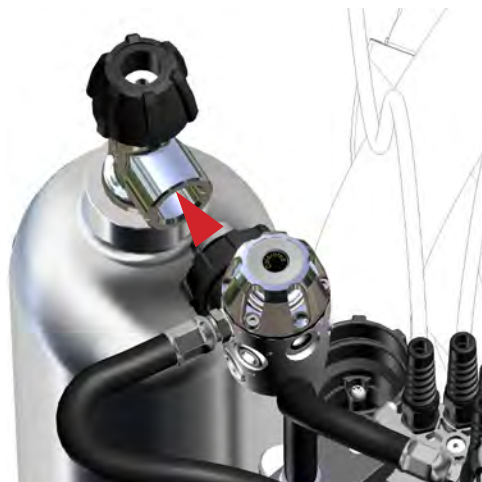
图 1-33.将稀释气调节器与稀释气气瓶 DIN 母螺纹对准。将其推入并手动锁紧稀释气调节器旋转螺母。
