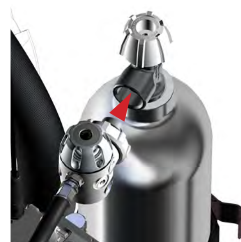
图 1-34.将氧气调节器与氧气瓶 DIN 母螺纹对准。将其推入并手动锁紧氧气旋转螺母。
