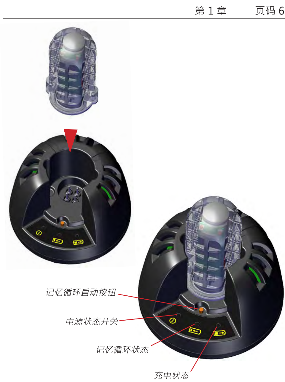
图 1-9. (左)：将智能电池插入台式充电站。电池螺柱与垂直槽对准；向下推电池，直至触点柱与偏心圆柱形接收孔接合。(右)：电池正确插入充电器。状态指示灯的定义见文本内容。
